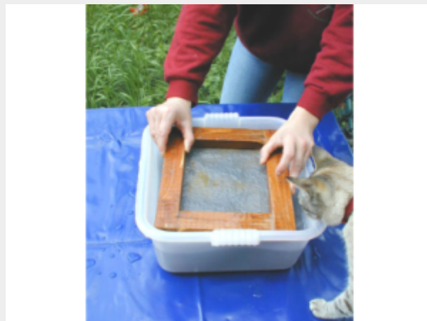
Figure 6 - Immergez le cadre dans une cuvette. Collectez une partie des suspensions de fibres puis enlevez doucement le cadre.
